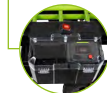
2 Akkufächer - es ist immer nur 1 aktiv 2 battery cartridges - only 1 is active at a time
