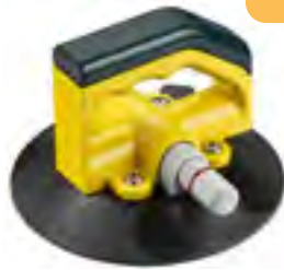
Ventosa de sucção a vácuo Material do Corpo: Plástico Material da Almofada: Borracha de 6" Capacidade de Carga: 30 kg
