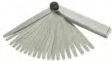
Apalpa folgas com 20 lâminas Medidas (mm): 0,05; 0,10; 0,15; 0,20; 0,25; 0,30; 0,35; 0,40; 0,45; 0,50; 0,55; 0,60; 0,65; 0,70; 0,75; 0,80; 0,85; 0,90; 0,95 e 1
