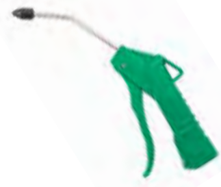
Pistola para ar de bico longo de 1/4" Comprimento: 100mm Pressão trabalho: 75-120psi Ruído: 85-90dba Fêmea: 1/4"
