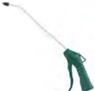
Pistola para ar de bico longo de 1/4" Comprimento: 280mm Pressão trabalho: 75-120psi Ruído: 85-90dba Fêmea: 1/4"
