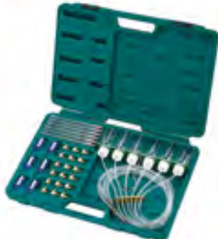
Dispositivo para teste de injetores common rail diesel Este dispositivo permite medir rápida e eficientemente a quantidade de combustível de retorno de cada injetor, permitindo assim verificar se existe alguma anomalia. Medição até 6 injetores em simultâneo. Inclui adaptadores para injetores Bosch, Delphi, Denso e Siemens.
